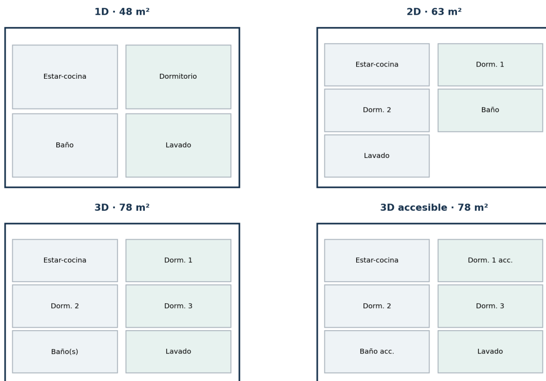
Figura 6. Esquemas funcionales de las cuatro tipologías de referencia. Las piezas no representan dimensiones contractuales.
